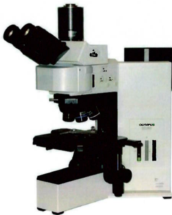
Figura 4.7 - Microscópio óptico Olympus BX60M [50].
