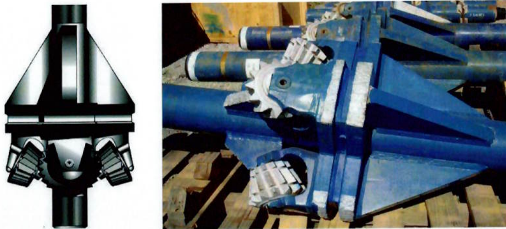
Figura 2.4 – Ilustração de um alargador [5] e foto da ferramenta.
