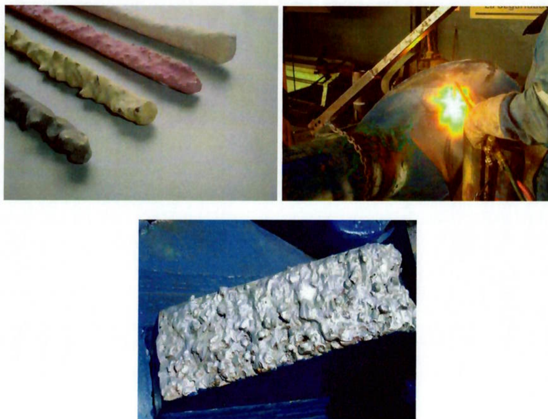
Figura 2.6 – Fotos das varetas do soldador e detalhes do revestimento.
