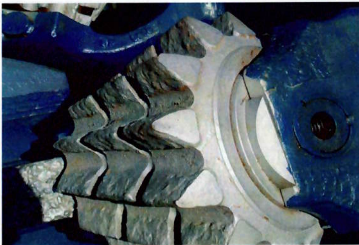
Figura 2.5 – Fotos dos dentes removíveis de um alargador.
